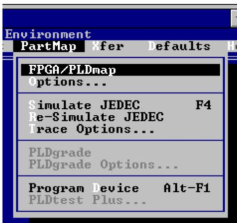
Erzeugung der zur Programmierung benötigten JEDEC-Datei. Festlegung der Programmierung („Mapping“).
