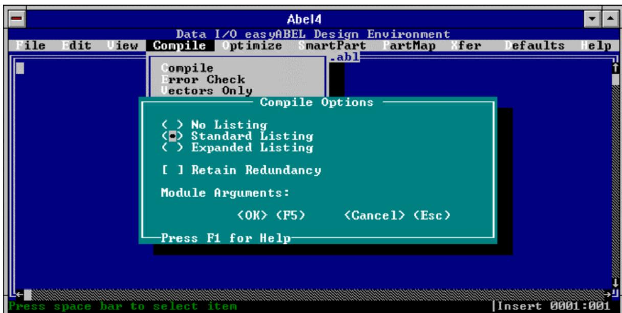
3. Mit Tab bzw. den vier Cursortasten können die Optionen ( hier z.B. „**Standard Listing**“ ) angewählt werden. Durch Druck auf die Leertaste ( **space** ) erfolgt die Auswahl. Die Auswahl muß mit < **OK** > abgeschlossen werden.
